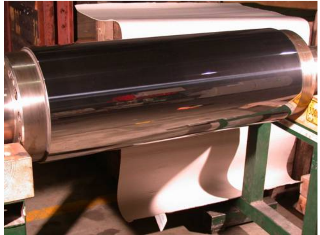
Mit DPC 169 Beschichtete Kalandervalze, Rauheit RA < 0,009 µM
